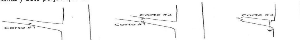
Fig. 1 Pasos para realizar los cortes con motosierra. (Técnica de los 3 cortes).
