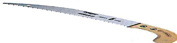
Fig. 2. Herramienta para podas de ramas con diámetro preferentemente menor a 13 cm.
