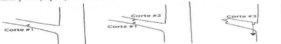
Fig. 1 Pasos para realizar los cortes con motosierra. (Técnica de los 3 cortes).
