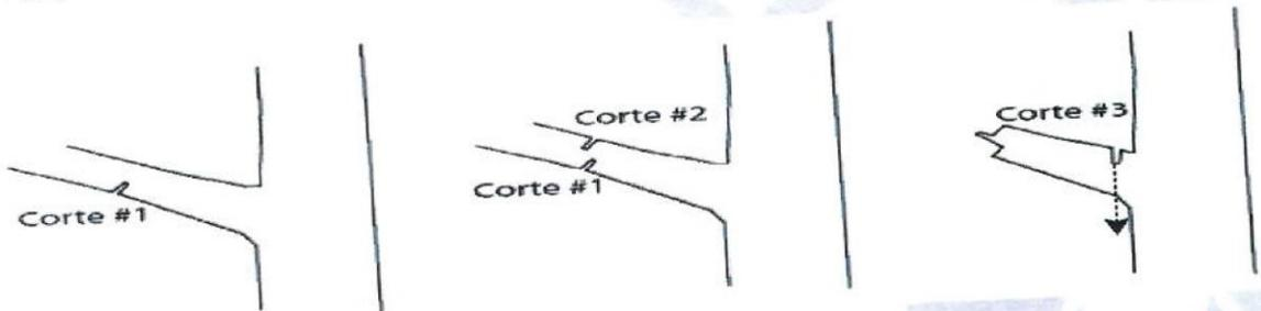
Fig. 1 Pasos para realizar los cortes con motosierra. (Técnica de los 3 cortes).
