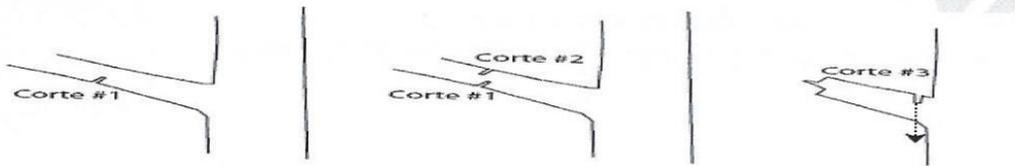
Fig. 1 Pasos para realizar los cortes con motosierra. (Técnica de los 3 cortes).
